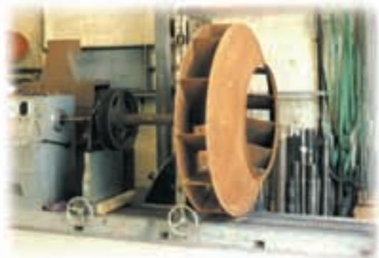
Alignement Laser sur ventilateurs (entraînement par poulie)
