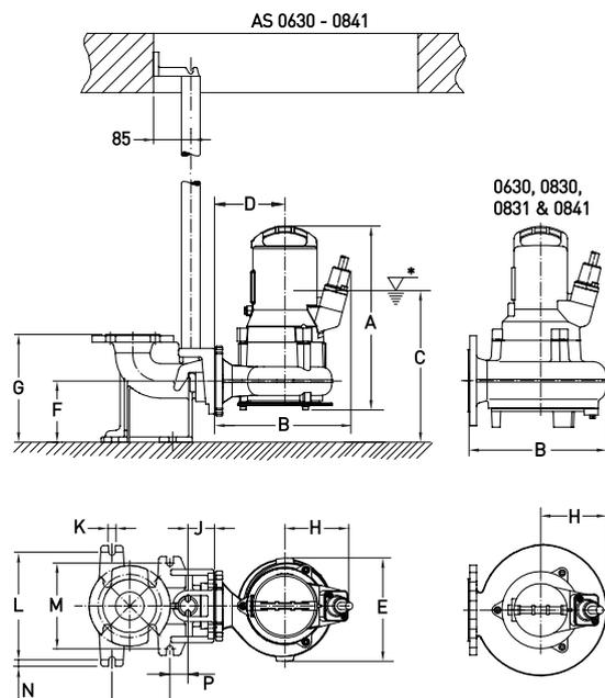
\* Niveau d'arrêt le plus bas; le niveau de mise en marche minimum est au moins 100 mm plus haut.
