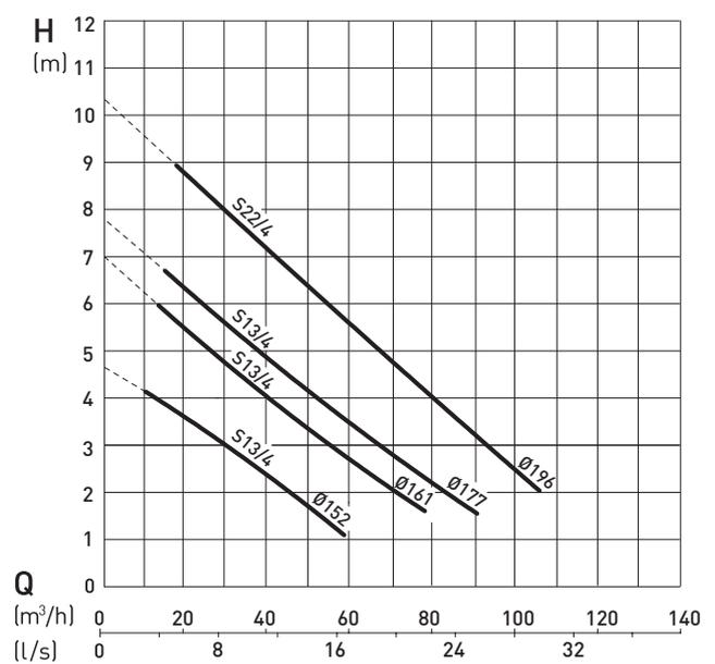
H = Hauteur totale, Q = Débit de refoulement. Courbes conformes ISO 9906. NB : veuillez utiliser le logiciel ABSEL pour valider le choix de la pompe.
