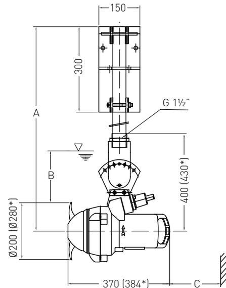
A = max. 2 m; B = min. 400 mm; C = min. 450 mm
