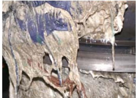
**La concentration en matières fibreuses dans l'eau est en augmentation, d'où des blocages plus fréquents. Les roues Contrablock Plus permettent à 80 % des matières fibreuses entrantes de passer à travers leur aube sans action de coupe, d'où une réduction considérable de l'usure sur la plaque de fond.**
