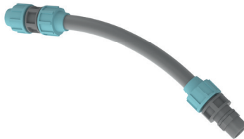
Kit de sortie de poste souple : KSS 40 1 raccord PVC et 1 tuyauterie souple (lg 600 mm) + 2 raccords à compression. Adaptable sur une canalisation PVC ou PEHD Ø40.
