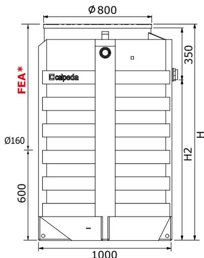
Poste livré avec 2 pompes 230V équipées de 10 m de câble chacune (descriptif pompes p. 195)
