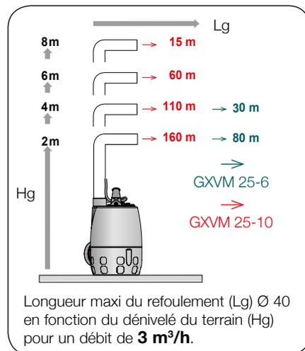
Longueur maxi du refoulement (Lg) Ø 40 en fonction du dénivelé du terrain (Hg) pour un débit de **3 m³/h**.
