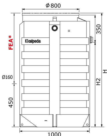
Poste livré avec 2 pompes 230V équipées de 10 m de câble chacune (descriptif pompes p.206)
