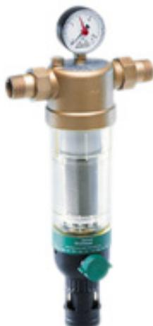
Le filtre à rinçage à contre courant F130 est destiné aux installations résidentielles ou tertiaires. Il assure continuellement une alimentation en eau filtrée. La filtration permet d'éviter un encrassement des installations par des particules solides externes, par exemple des particules de rouille ou des grains de sable. Il peut être équipé d'un moteur de rinçage automatique et d'un capteur de pression différentielle d'encrassement pour un fonctionnement autonome.
