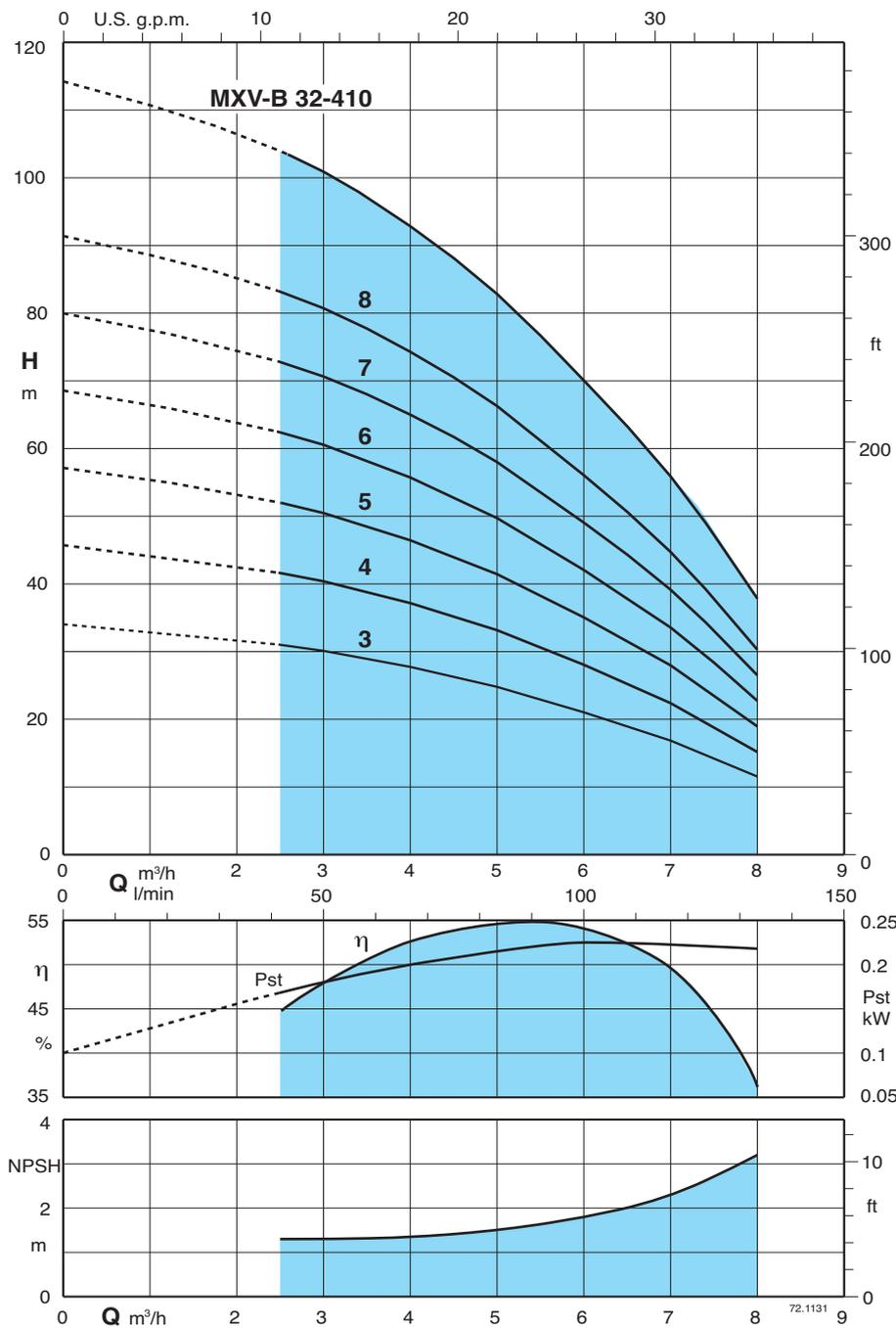
Résultats des essais avec eau propre et froide, sans gaz.
