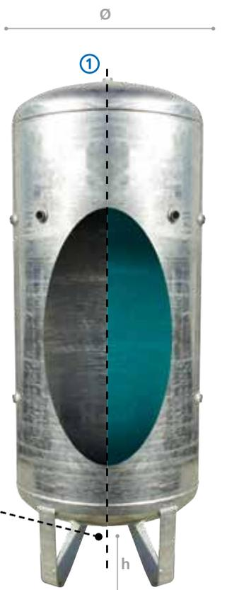
Réservoir avec traitement de galvanisation à chaud à l'extérieur selon directive 1935/04/CE, et traitement alimentaire Vitroflex à l'intérieur. Température d'utilisation -10°C / +50°C.
