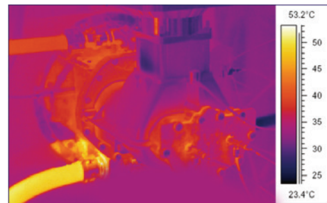
Élévation de température limitée de 25°C seulement dans l'élément de compression
