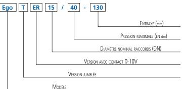
Pompe de circulation à rotor noyé à haut rendement avec orifices filetés, moteur à aimants permanents et réglage électronique intégré.
