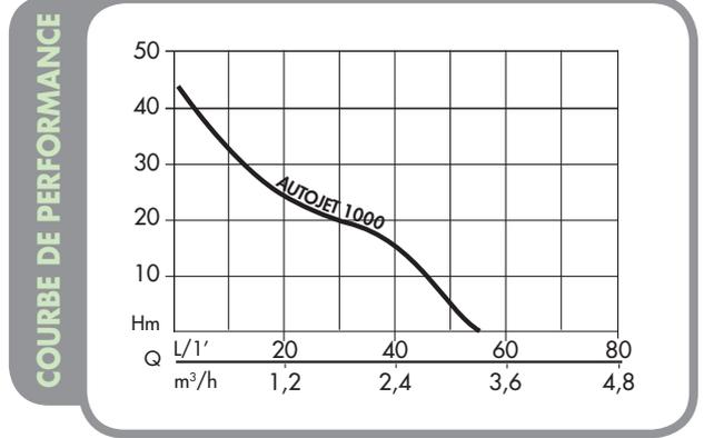
Les pompes AUTOJET sont équipées d'un dispositif électronique qui contrôle le flux et la pression et commande la mise en marche de la pompe sur simple demande d'eau. Les pompes AUTOJET peuvent être utilisées comme pompes automatiques pour pressuriser et automatiser l'installation hydrique de la maison.
