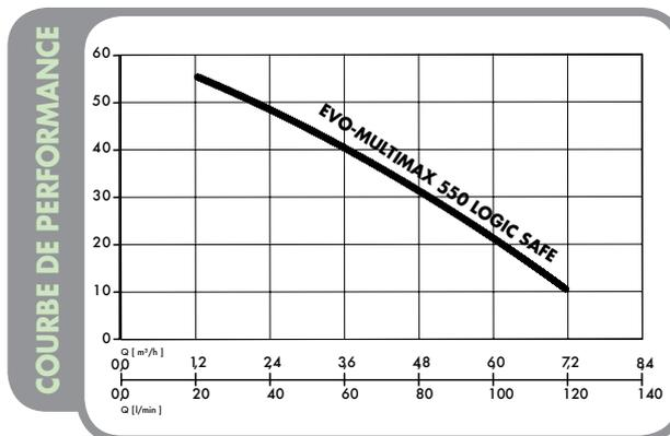
Pompe de surface pour arroser, irriguer et fournir de la pression à l'installation hydrique domestique. EVO-MULTIMAX 550 LOGIC SAFE est une pompe auto-amorçante avec système hydraulique multicellulaire et corps de pompe en acier inox. Le dispositif électronique intégré assure une protection contre la marche à sec, contre le surcharge moteur et contre l'échauffement de la partie hydraulique.
