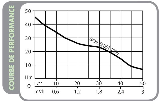
Pompe de surface pour arroser et pour fournir de la pression à l'installation hydrique domestique. GARDENJET 1000 est une pompe monophasée auto-amorçante avec turbine JET pour garantir un rendement plus important.
