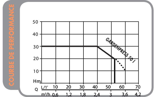
**Groupe de surpression auto-amorçant avec corps de pompe en fonte et réservoir 50L**
