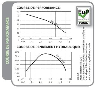
Pompe submersible pour puits, pour arroser et pour fournir de la pression à l'installation hydrique domestique. SUB 8S Plus est une pompe professionnelle avec corps de pompe, arbre et cage moteur en acier inox, qui permet de laisser la pompe en permanence immergée sans risques de corrosion. SUB 8S Plus est équipée
