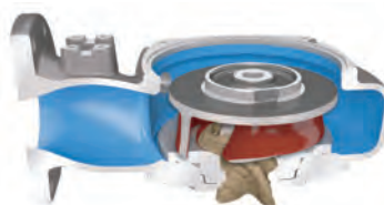
Étape 1 : les aubes de la roue N avec ses bords d'attaque inclinés vers l'arrière guident les solides du centre vers la périphérie de la roue.
