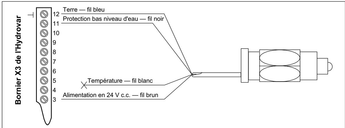
Schéma de câblage pour le CPC Aquavar<sup>MD</sup>
