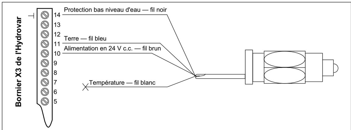
Schéma de câblage pour le relais de 15 V c.c.
