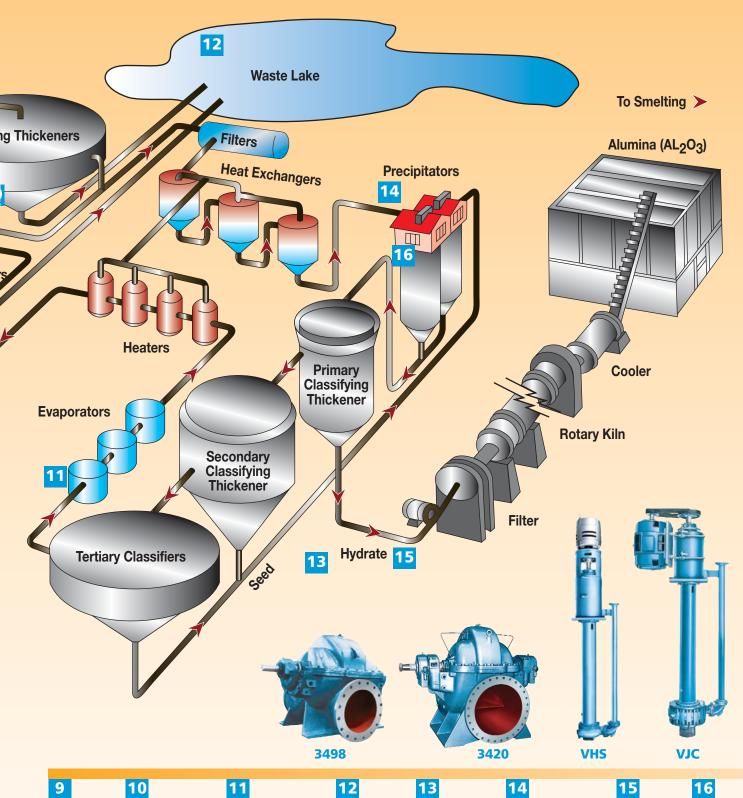
**Evaporation** Sump Mud **Precipitation Hydrate Filter Feed** Sweetner **Pumps** - 3196 **Disposal Service** - 5500 - 5500 - 3196 - VHS - 3180 - 3180 - 5500 - 5500 - 3410 - 3410 - 3409 - 3409 - 3498 - 3420 **Dependent**
