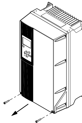
Fig. 24 Accès aux bornes de signaux, A4, A5, B1, B2, B3, B4, C1, C2, C3 et C4
