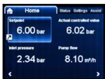
La communication avec le surpresseur est possible via le panneau de contrôle de la pompe ou en utilisant Grundfos GO et à distance par le biais d'un système de gestion décentralisé.
