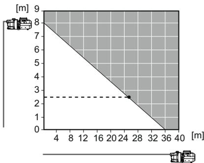
Exemple, si la hauteur d'aspiration est de 2,5m, la longueur au refoulement ne pourra pas excéder 25 m.
