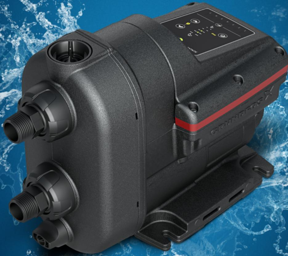
Le GRUNDFOS SCALA2 est un surpresseur entièrement intégré qui fournit la bonne pression d'eau à tous les robinets. Il est composé d'une pompe, d'un moteur, d'un réservoir et d'un clapet anti-retour dans une seule unité, facile et rapide à installer. Grâce à sa commande intelligente, le SCALA2 ajuste sa performance en fonction des besoins et son moteur refroidi à l'eau lui permet de fonctionner en silence. L'utilisateur bénéficie d'un confort maximal à moindre effort.
