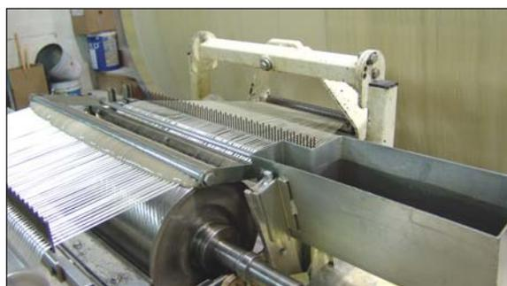
Cette méthode de transformation permet d'obtenir une résistance supérieure à une méthode traditionnelle d'enroulement orthogonal.
