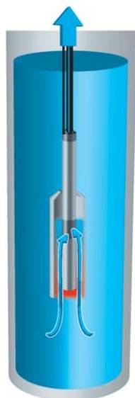
Lorsque la pompe est dans un puits de large diamètre, l'eau ne circule plus que par convection autour du moteur, cela est suffisant pour les moteurs de petite taille, jusqu'à 1,1 kW. A partir de 1,5 kW, nous conseillons d'installer une chemise de refroidissement autour du moteur pour forcer le passage de l'eau.
