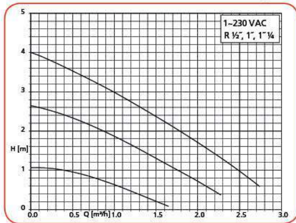
Calio S 15/25/30-40 fonctionnement non régulé
