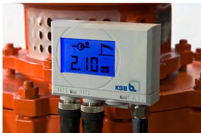
PumpMeter est un capteur de pression intelligent avec affichage des valeurs mesurées (remplace un kit mano) et des caractéristiques de fonctionnement. L'appareil est doté de deux capteurs de pression et d'un module d'affichage. Il enregistre le profil de charge de la pompe pour signaler les potentiels d'optimisation éventuels en termes d'efficacité énergétique et de disponibilité.
