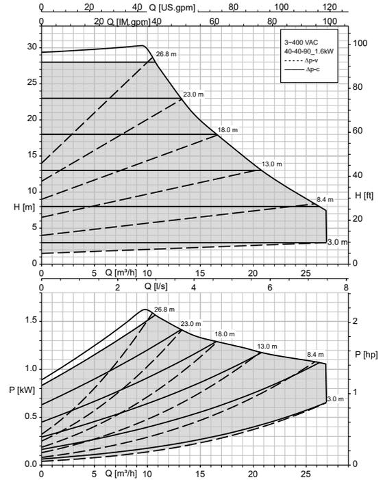
**EtaLine Pro 40-40-90\_2,6kW Vitesse constante (fonctionnement boucle ouverte), Eco-Mode**
