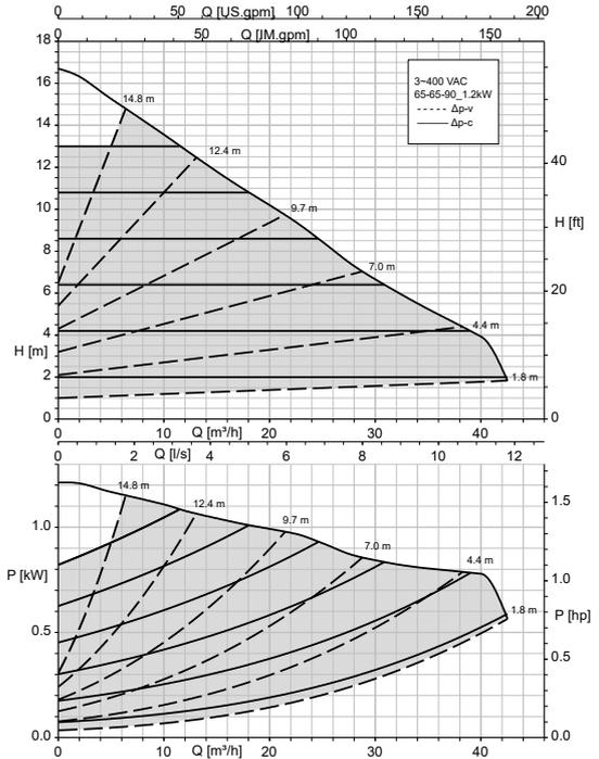
**EtaLine Pro 65-65-90\_2,0kW Vitesse constante (fonctionnement boucle ouverte), Eco-Mode**
