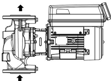
III. 4: Installation horizontale du groupe motopompe, sens d'écoulement de bas en haut
