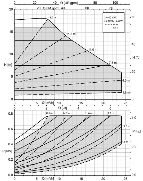
**EtaLine Pro 40-40-90\_1,3kW Vitesse constante (fonctionnement boucle ouverte), Eco-Mode**
