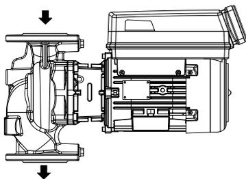
III. 5: Installation horizontale, sens d'écoulement de haut en bas
