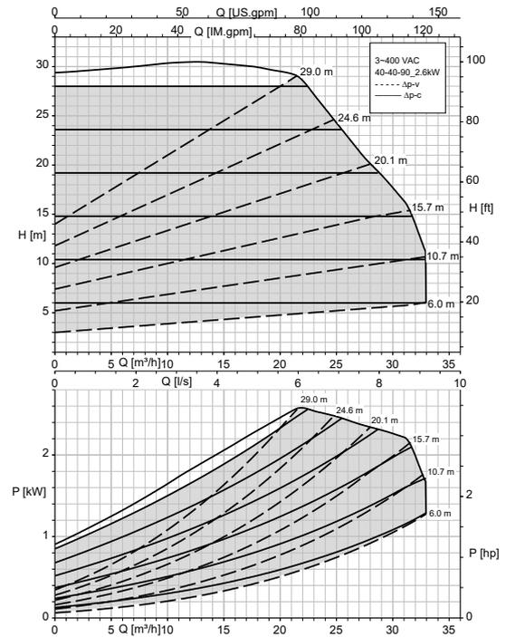
**EtaLine Pro 50-50-90\_0,8kW Vitesse constante (fonctionnement boucle ouverte), Eco-Mode**
