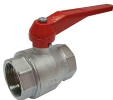
Le montage d'un robinet à tournant sphérique au refoulement est recommandé pour pouvoir démonter la station de relevage des eaux vannes de la tuyauterie de refoulement en cas d'incident ou de maintenance sans que le volume entier contenu dans la tuyauterie de refoulement reflue vers la station de relevage (voir EN 12056-4).
