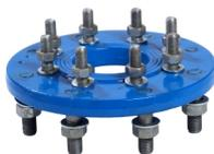
Le raccordement de stations de relevage Compacta de taille supérieure peut nécessiter, selon les conditions d'installation, une bride permettant de réaliser le passage de DN 100 à DN 150. KSB propose pour cela une bride d'adaptation.
