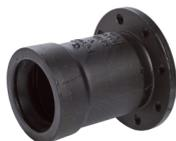
Manchon à bride en fonte grise (pièce EU) pour le raccordement de tuyaux en fonte ductile côté arrivée d'une station de relevage des eaux vannes (en cas d'utilisation d'un robinet-vanne à brides côté arrivée, par exemple). Le tuyau arrivant, équipé d'un joint torique qui assure l'étanchéité, est introduit dans le manchon à bride.
