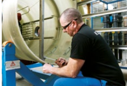
Montage d'une station SRS. Usine KSB de Déville-lès-Rouen (76)
