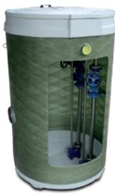
**Station de Relevage Préfabriquée pour eaux usées chargées**, avec cuve en composite pour installation enterrée. Respecte les prescriptions de la norme EN 12050-1. La station est équipée de deux pompes submersibles montées sur pied d'assise avec système de guidage. Tuyauterie de refoulement complète en PVC, avec vannes à boisseau sphérique et clapets anti-retour à boule montés dans la cuve ou dans un regard externe.
