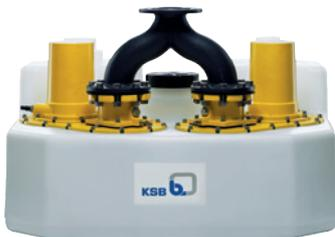
**Station de relevage inondable pour eaux usées chargées** contenant des eaux vannes conforme à la norme EN 12050-1. Réservoir collecteur en matière synthétique. Ensemble équipé de pompes, de capteurs et d'un coffret de commande.
