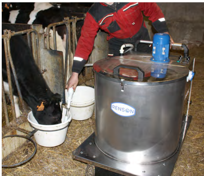
Distribution individuelle des rations avec contrôle des quantités par compteur numérique
