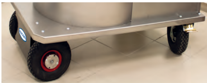
Chariot motorisé avec variateur de vitesse et roues directrices. Batteries rechargeables en monophasé.
