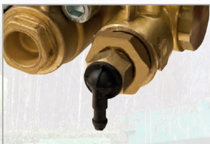
Vanne de décharge thermique Protège la pompe contre la surchauffe de l'eau lorsqu'elle fonctionne en by-pass
