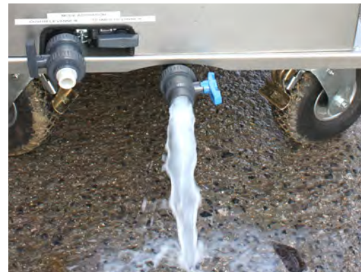
Vanne de vidange de cuve
