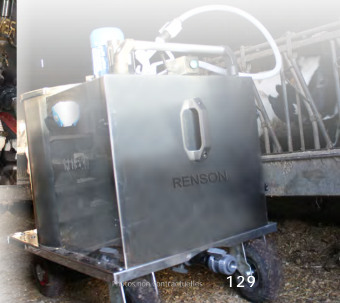
Système de chauffage exclusif en circuit fermé avec pompe à membrane alimentaire
