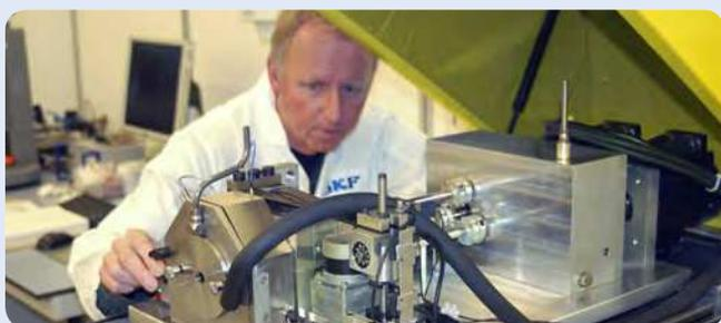
Ces connaissances ont souvent conduit SKF à établir des normes industrielles en termes de test de lubrifiants pour roulements. Emcor, ROF, ROF+, V2F, R2F et Bequiet ne représentent que quelques uns des nombreux tests mis au point par SKF pour évaluer les performances des lubrifiants dans les conditions de fonctionnement des roulements. Grand nombre d'entre eux sont couramment utilisés par des fabricants de lubrifiants du monde entier.
