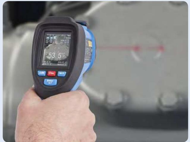
Lorsqu'il est utilisé en mode sans-contact, le thermomètre détecte l'énergie thermique rayonnée par l'objet grâce au détecteur infrarouge. Pointé vers un objet, le détecteur infrarouge capte l'énergie, produisant un signal que le microprocesseur traduit par une valeur affichée sur l'écran rétro-éclairé. Tant que la gâchette est enfoncée, la température de l'objet est mesurée en continu par le détecteur infrarouge. Ceci permet d'obtenir des valeurs affichées en temps réel rapides et précises.
