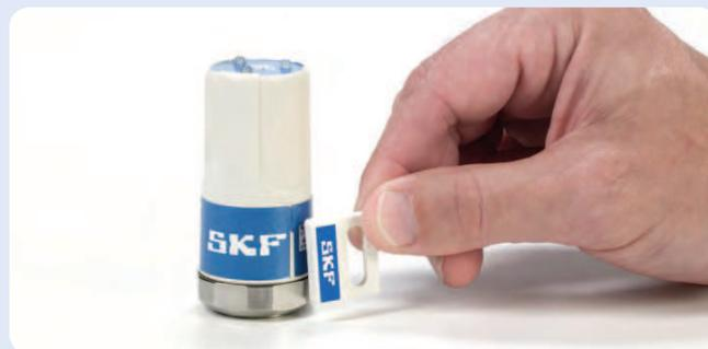
Une clé magnétique est incluse pour programmer l'indicateur d'état SKF MCI. Elle sert à activer l'indicateur, à changer de mode de programmation, à régler les valeurs de référence pour les vibrations, à acquitter les alarmes et à réinitialiser l'indicateur.
