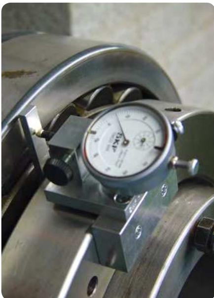
Utilisation sur les écrous hydrauliques SKF HMV ou HMVC d'ancienne génération
