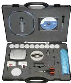
Kit portable d'analyse de graisse pour utilisation sur site
