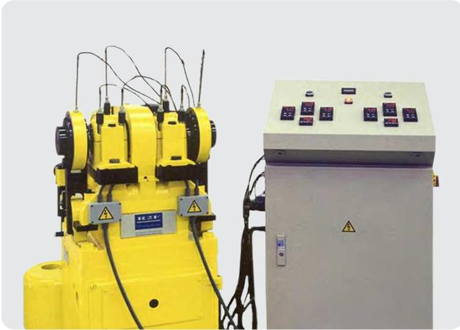
Banc de test de graisse R2F
