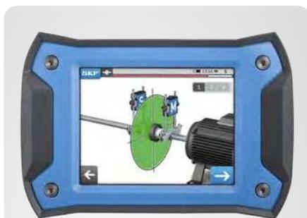
La mesure libre permet de démarrer les mesures d'alignement dans n'importe quel angle tout en finalisant avec balayage angulaire final de seulement 90°.
