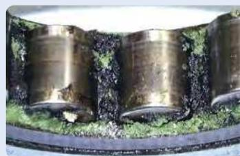
Dégradation du lubrifiant due à des courants de décharge
