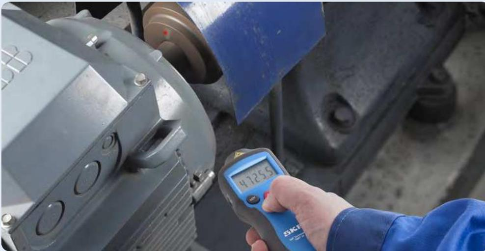
Le système optique laser permet des mesures simples et rapides, à distance en toute sécurité, des machines rotatives
