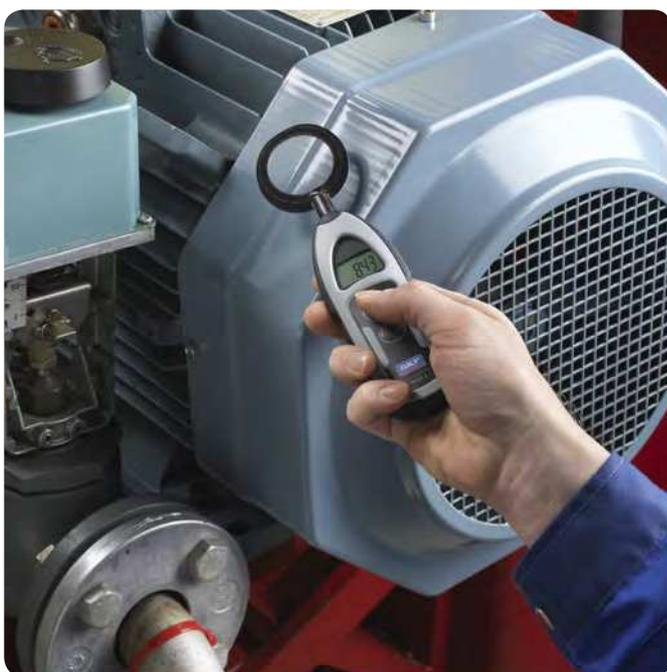
Le risque d'érosion électrique du roulement est augmenté en cas d'utilisation de variateur de vitesse sur les moteurs électriques. Dans le cadre d'un programme de maintenance prédictive, le détecteur SKF TKED 1 aide à identifier rapidement les roulements les plus exposés et à réduire les risques d'arrêts-machines non planifiés de façon significative.
