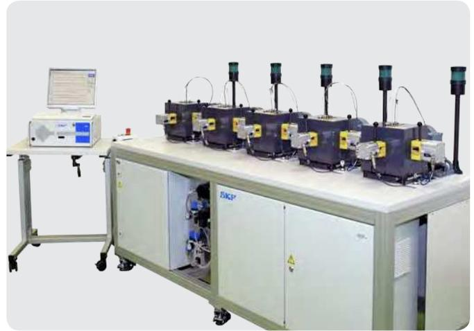
Banc de test de graisse ROF+
