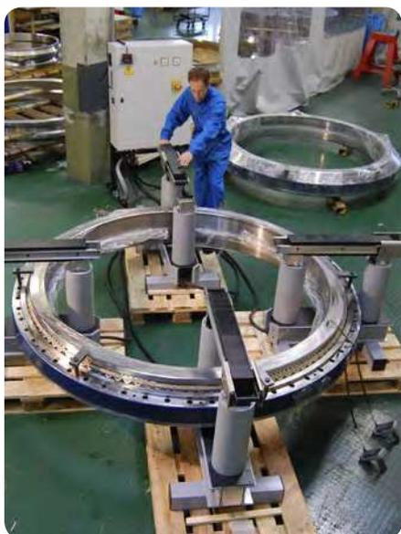
Une solution de chauffage unique et flexible pour les pièces mécaniques et roulements de très grande dimension
