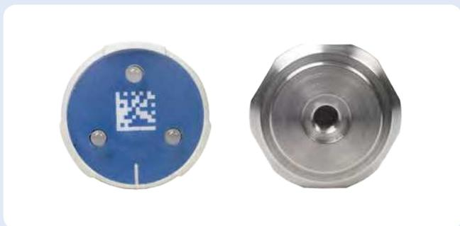
Le dessus de l'indicateur d'état SKF MCI comporte 3 LED qui indiquent l'état des roulements et l'état général de la machine. En outre, il dispose d'un flash code QR indiquant un numéro de série pour permettre d'identifier la machine et de l'intégrer facilement à un programme de fiabilité pilotée par l'opérateur (ODR), de routes de maintenance ou de contrôles planifiés. La base en acier inoxydable a un taraudage 1/4-28 pour le montage des goujons.
