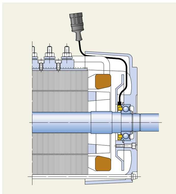
*Le roulement-capteur SKF, qui ne nécessite aucun espace supplémentaire, est bien protégé à l'intérieur du moteur et fournit un signal fiable, de qualité constante*
