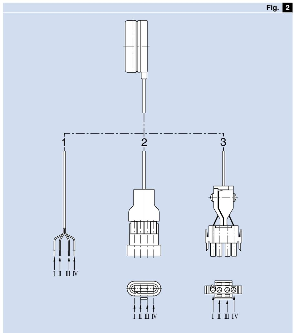
Les différentes versions de câble de raccordement
