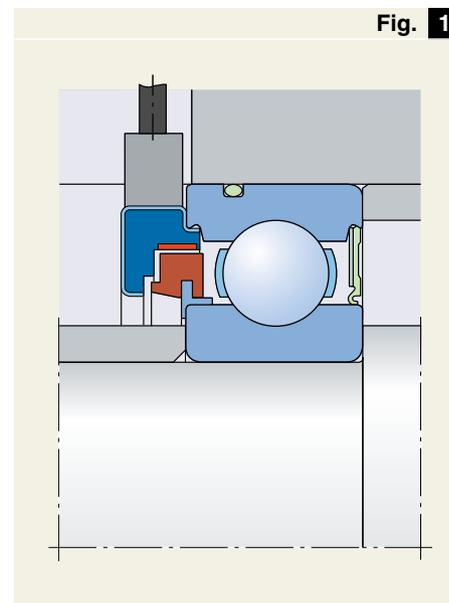
*Encoche dans le couvercle et fixation de la bague extérieure par un joint torique placé dans la gorge du segment d'arrêt*
