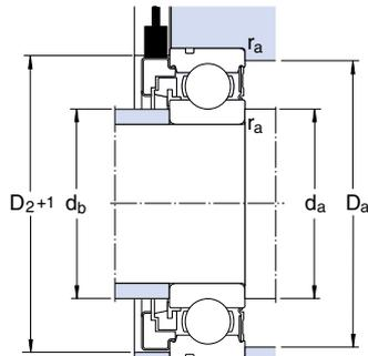
Diamètre d'alésage du couvercle  $\geq D_2 + 1$  (mm)
