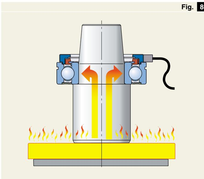
*Assemblage vertical d'un couvercle extérieur sur le roulement-capteur*
