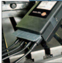
Possibilité de raccorder jusqu'à 4 sondes de ventilation au choix par enregistreur
