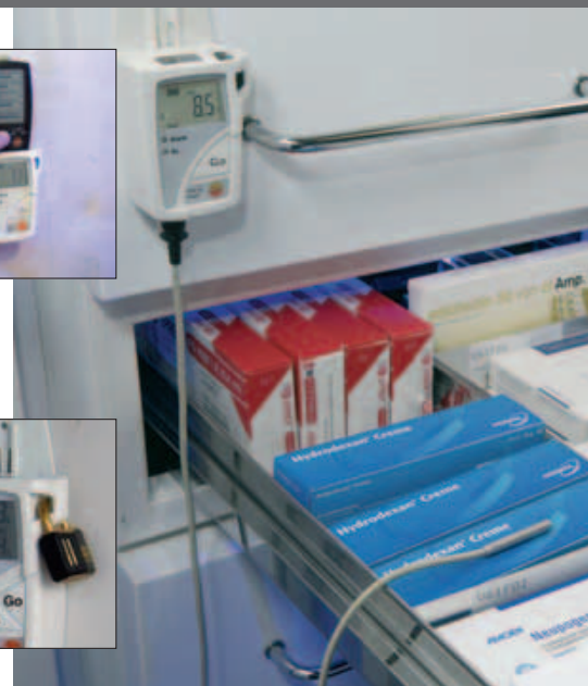
Surveillance de deux températures simultanément, en production
