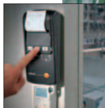
Documentation des données de mesures sur site avec l'imprimante testo 575 (option)
