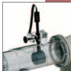
Aperçu de la position exacte de la sonde dans la mini-soufflerie
