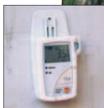
Enregistreur testo 175-T1, avec afficheur
