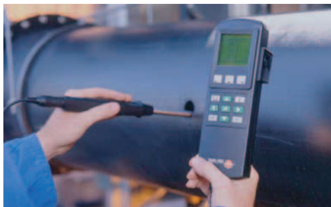
Mesure d'humidité en biofiltre. Avantage: Mesures précises en milieu très humide ou en cas de variations de température sans que la sonde ne soit couverte de rosée évitant ainsi des erreurs de mesure.
