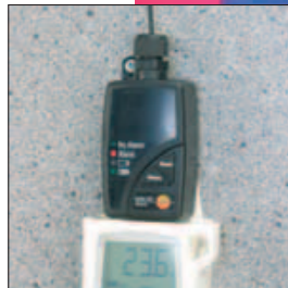
testo 581 - Recopie du signal d'alarme
