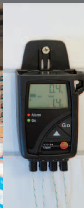
Mesures simultanées sur 4 localisations différentes
