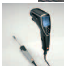
Entrée de sonde TC pour la détermination du coefficient d'émissivité
