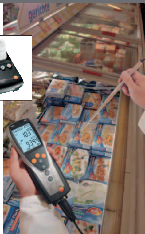
Contrôle du brassage de l'air dans un congélateur
