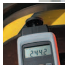
testo 470, mesure sans contact et mécanique de la vitesse de rotation
