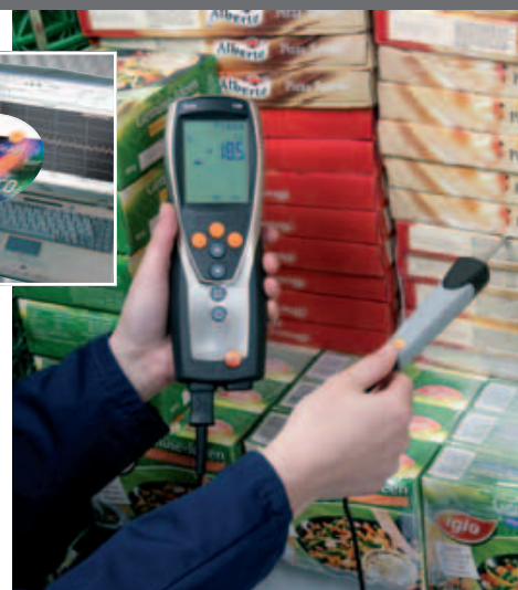
Contrôle de température dans une chambre froide
