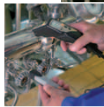
testo 830-T4: Détermination du degré d'émission avec sonde de température externe
