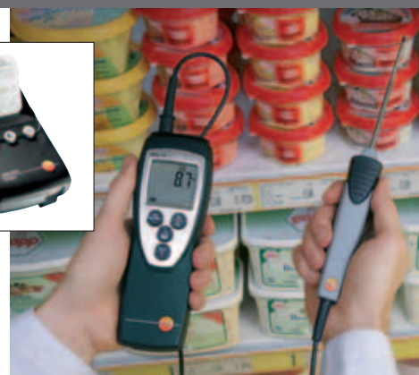
Vérification de linéaires et de rendement frigorifique
