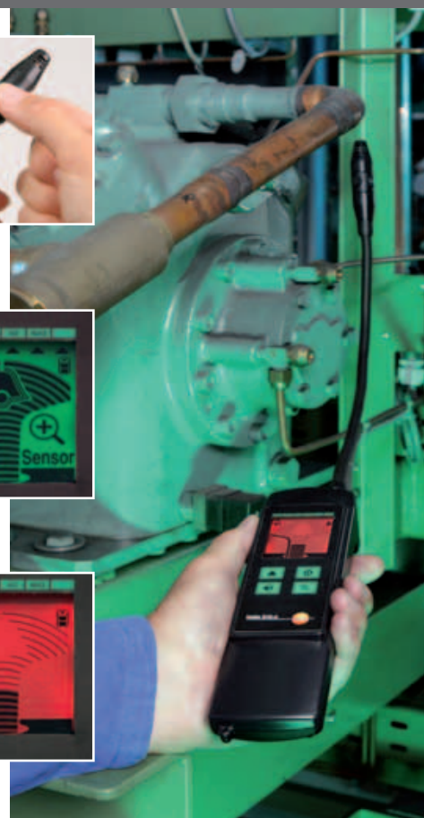
Détection rapide et précise des fuites sur une installation frigorifique ou une pompe à chaleur
