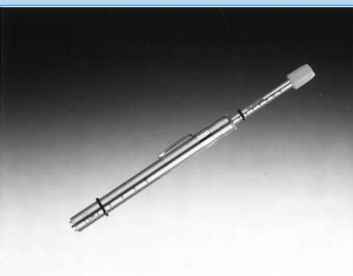
Le tensiomètre permet de mesurer la tension statique d'une courroie de transmission au cours d'un arrêt de l'installation.
