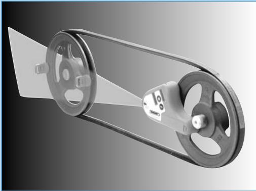
L'outil d'alignement laser TEXROPE® ATX offre une méthode rapide et précise pour mesurer le désalignement.
