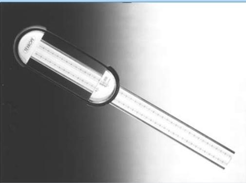
Le mesureur, de fabrication robuste en métal, permet de mesurer les courroies trapézoïdales classiques et étroites dont les longueurs primitives sont comprises entre 540 et 2500 mm, soit environ 60% du nombre des courroies industrielles commercialisées.
