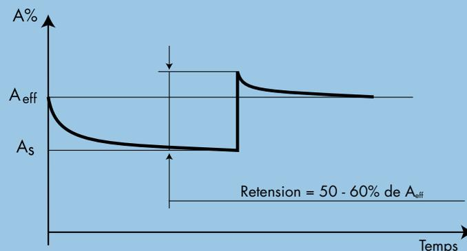
Vérifier de nouveau la tension après 24 h ou 48 h de fonctionnement. Retendre à nouveau si nécessaire.
