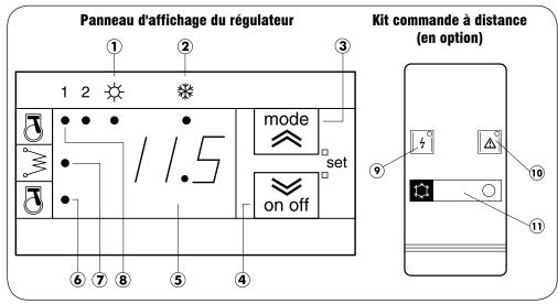
Le régulateur fournit les informations sur les états de fonctionnement, la configuration et les alarmes à l'aide d'un afficheur et des LEDs se trouvant sur le panneau d'affichage.
