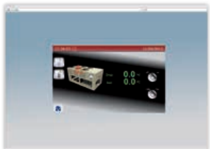
A partir de cet écran nous pouvons configurer un programme horaire, pour le démarrage et pour tous les éléments.
