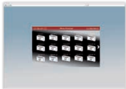
Nous pouvons accéder à chaque fanCoil, à partir de celui-ci nous pouvons le placer sur ON-OFF, modifier le setpoint, sélectionner la vitesse automatique ou manuelle (faible, moyenne ou grande) et de voir l'état, froid ou chaud.
