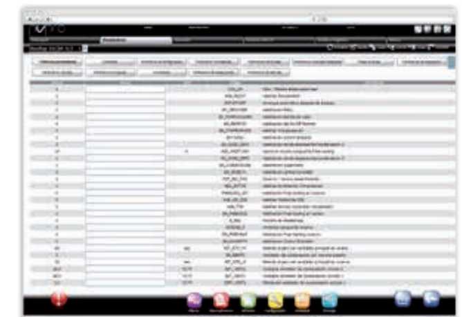
Écran avec liste complète des paramètres (accès selon le niveau de l'utilisateur) : permet la lecture/modification des valeurs, ainsi que de les sauvegarder (copie de sécurité).
