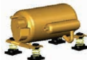
Compresseur monté sur ressorts
