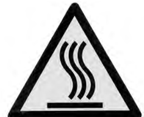
Avertissement zones à haute température À côté des conduites ou des composants chauds
