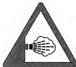
Avertissement décharges de soupapes de sûreté
