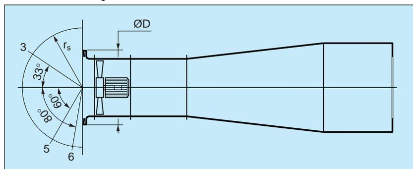
$r_s$ : rayon de l'hémisphère de mesure en m -  $D$ : diamètre d'entrée de l'ouïe d'aspiration en m -  $r_s$ :  $1 + 0,5 D$
