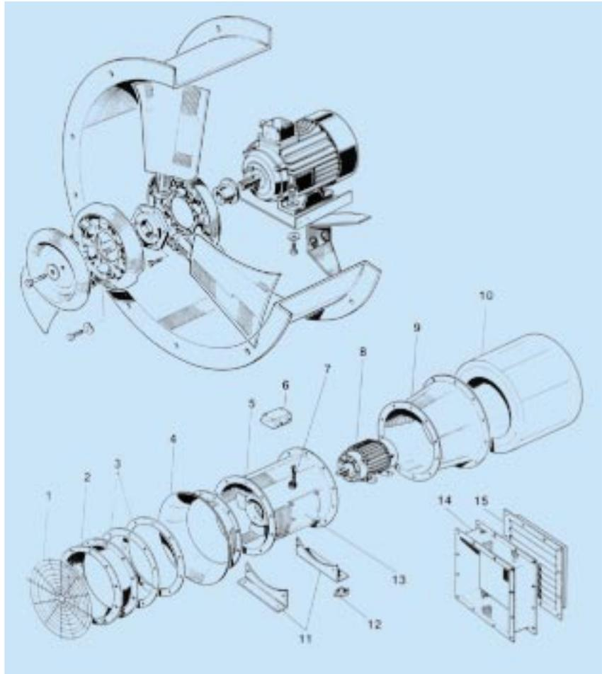
1. Grillage de sécurité conforme à la Norme NF E 51.190
