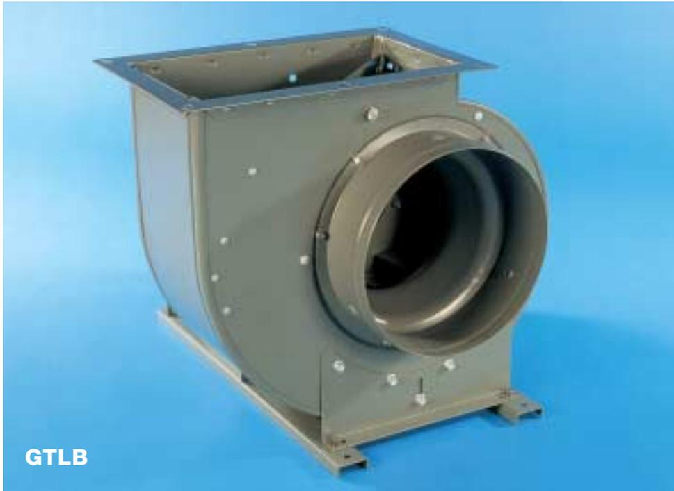
Ventilateur centrifuge à simple ouïe et entraînement direct. L'enveloppe du ventilateur est en tôle d'acier galvanisé "sendzimir", assemblée selon la méthode "Pittsburg".
