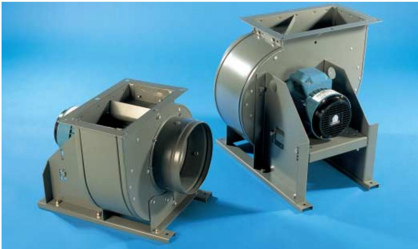
Les ventilateurs centrifuges à entraînement direct à simple ouïe CENTRIMASTER GT couvrent une plage de débits d'air allant jusqu'à 7 m<sup>3</sup>/s, avec une augmentation de pression maximale de 2000 Pa. La série de ventilateurs comporte des ventilateurs centrifuges à deux types de roue :
