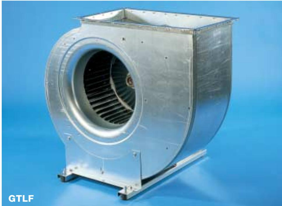
Ventilateur centrifuge à simple ouïe et entraînement direct. L'enveloppe du ventilateur est en tôle d'acier galvanisé "sendzimir", assemblée selon la méthode "Pittsburg". Roue de ventilateur avec aubes inclinées vers l'avant, fabriquée en acier galvanisé "sendzimir". Équilibrage dynamique de la roue du ventilateur avec la précision G 6.3 de la norme ISO 1940 – 1973. Les performances ont été évaluées selon AMCA 210-85 et 300-85.
