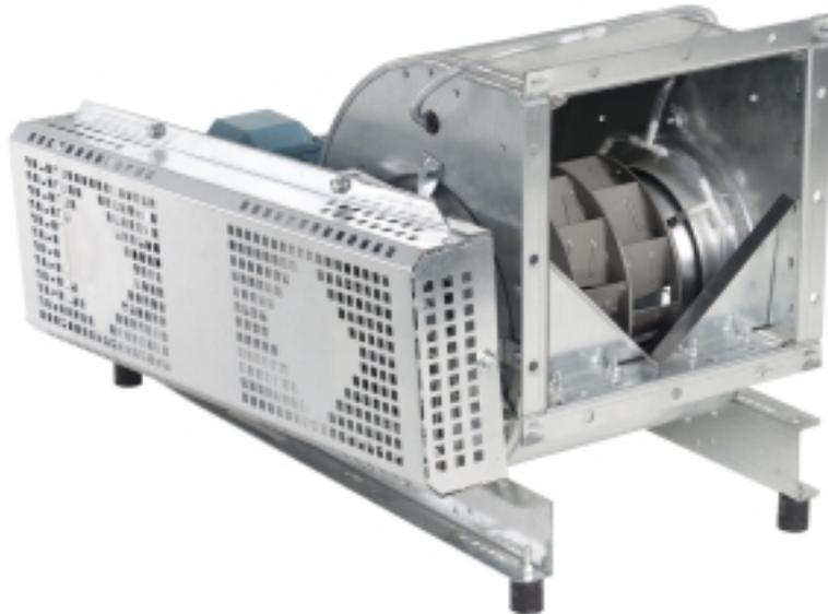
Les ventilateurs centrifuges à entraînement par courroies à double ouïe CENTRIMASTER GT couvrent les débits d'air allant jusqu'à 50 m<sup>3</sup>/s, avec une augmentation de pression maximale de 3300 Pa. La série de ventilateurs comporte des ventilateurs centrifuges à deux types de roue :
