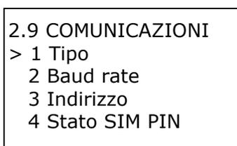
In TIPO si seleziona il tipo di interfaccia tra GSM, RS232, RS485, RS232-DB9. I primi tre richiedono la presenza del modulo aggiuntivo, il quarto (RS232-DB9) si riferisce al connettore femmina 9 poli (DB9) che è sempre presente. Nel caso sia selezionato GSM verranno richiesti i seguenti ulteriori parametri:
