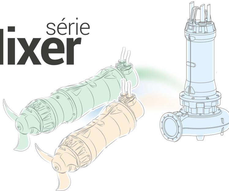
Un solide réducteur épicycloïdal a été privilégié au moteur à grand nombre de pôles pour optimiser la fiabilité mécanique, lorsque l'hélice doit tourner à bas régime dans les applications avec boues à forte concentration de corps solides.
