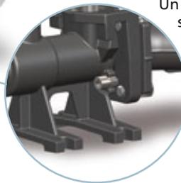
Un détail technique particulier réalisé sur le corps OXY permet la fixation mécanique (par vis) entre la bride de refoulement de l'éjecteur et la bride de coulissement accouplée à l'électropompe, ce qui rend le système solidaire et, par conséquent, approprié à une installation mobile.
