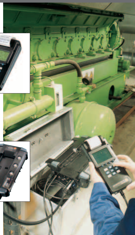
Mesure simple et conviviale sur des moteurs pour le contrôle et le réglage sur site
