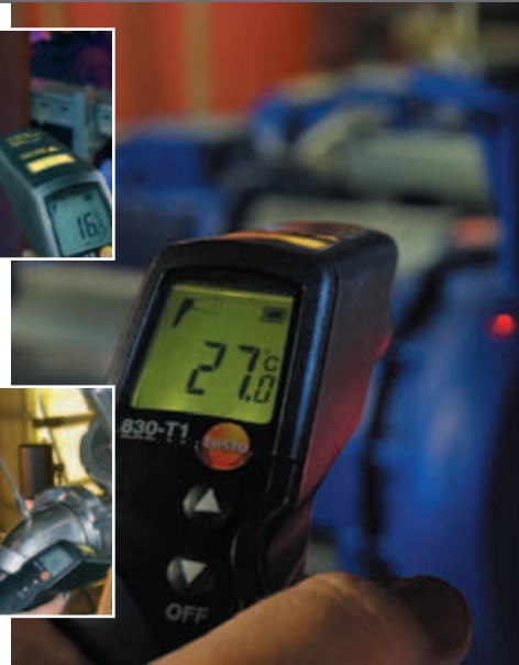
Contrôle rapide de la température sur des équipements techniques
