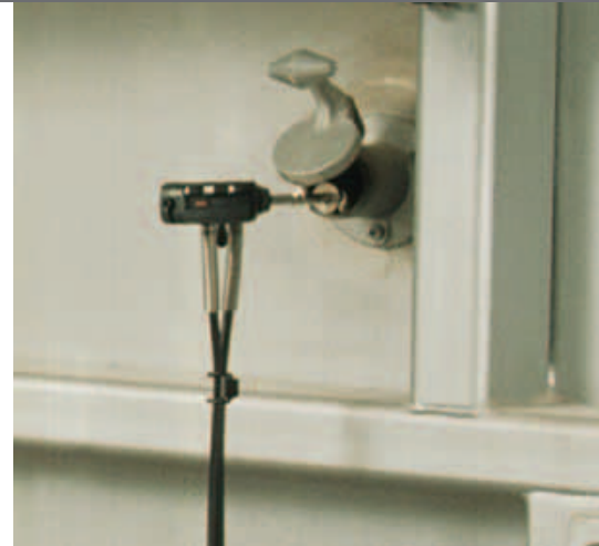
Sonde de prélèvement de gaz standards, disponible dans les longueurs 335 mm et 700 mm
